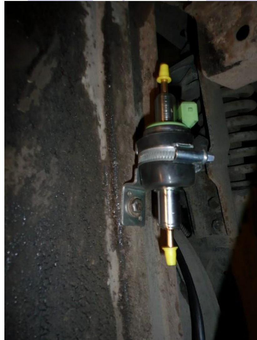
Рекомендуется устанавливать в подкабиное пространство ( между топл.баком и отопиелем)
