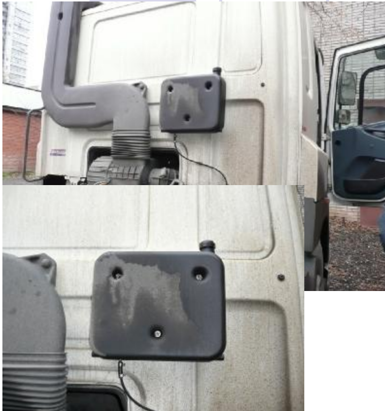
Крепление болтами к задней стенке кабины
